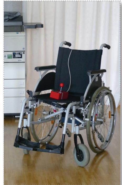
Abb. 2: Rollstuhl mit der „Fernsteuerung“ (in Rot)
