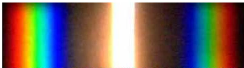
Der Schirm wird nun so verschoben, dass der Spektralanteil – z.B. blau – auf der Schirmkante liegt. Der Abstand vom 0.Maximum zu blau ist dann die halbe Schirmbreite. Diese Breite wird gemessen und ebenso der Abstand vom Schirm zum Gitter.
