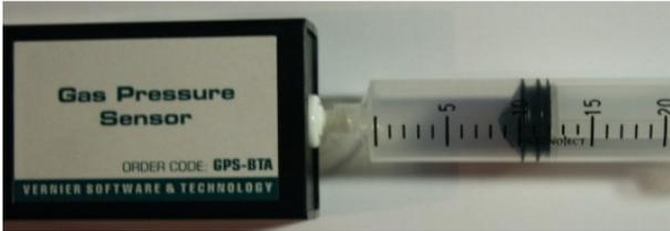
20ml Luft in Spritze wird komprimiert; manual Input
