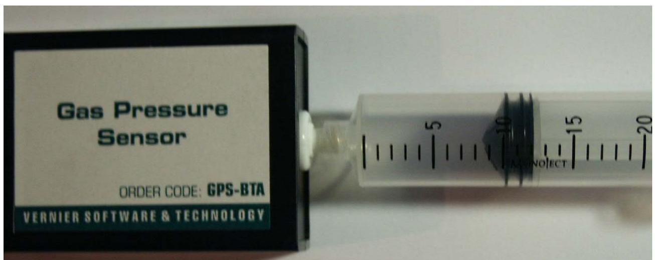
Die Luft in einer Spritze wird langsam komprimiert. Dabei liefert ein Gasdrucksensor den aktuellen **Gasdruck p** in der **Einheit kPa**, die Größe des **Volumens V** wird an der Spritze (Gesamtvolumen ist 20 ml = 20 cm<sup>3</sup>) eingestellt und manuell dem Messprogramm eingegeben. Mache eine Online-Messung. Die Messdaten werden in einem p-V-Diagramm dargestellt und analysiert.
