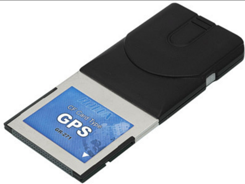
Externer GPS – Empfänger Compact-Flash Steckkarte
