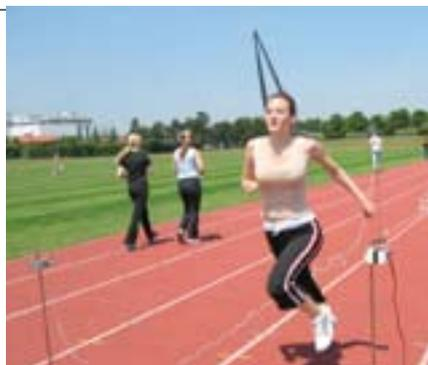
Laserlichtschranken-Messstrecke zur Ermittlung von 10 Zwischenzeiten bzw. Abschnittsgeschwindigkeiten
