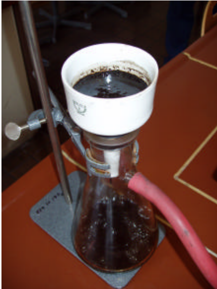
Abb. 3. Abfiltrieren der Rohcellulose
