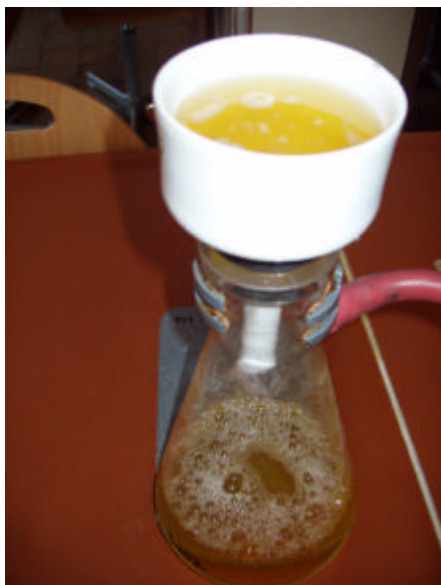
Abb.5 Abfiltrieren der gebleichten Cellulose
