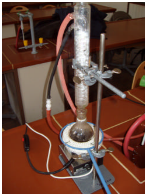
Abb.2 Rückflusskochen der Holzspäne mit einem Gemisch aus konzentrierter Essigsäure und Salzsäure.
